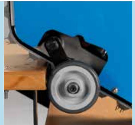
Ruote automatiche sempre attive che si adattano autonomamente al vuoto/pieno del gradino e agevolano la traslazione in piano
